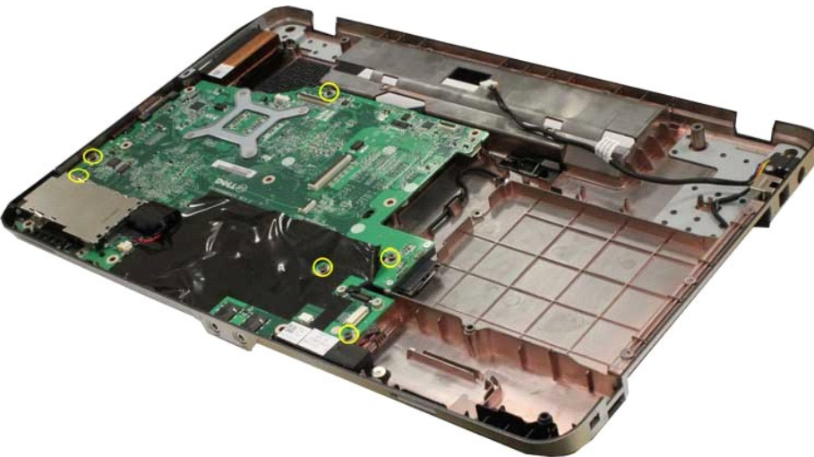
19. ยกบอร์ดระบบออกจากโครงเครื่องคอมพิวเตอร์
