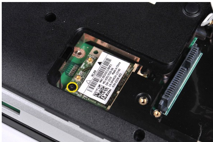
7. เลื่อนการ์ด WLAN ออกจากช่องใส่การ์ดบนบอร์ดระบบโดยทำมุม 45 องศา
