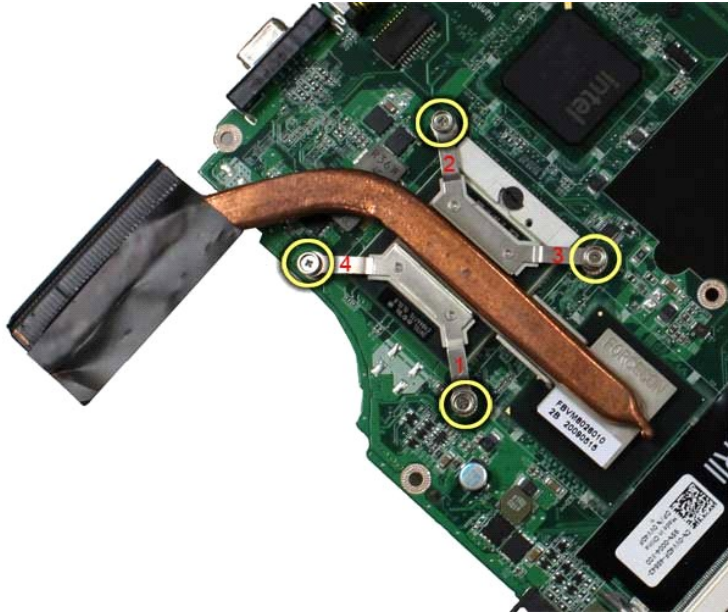
18. ยกชุดระบายความร้อนออกจากบอร์ดระบบ
