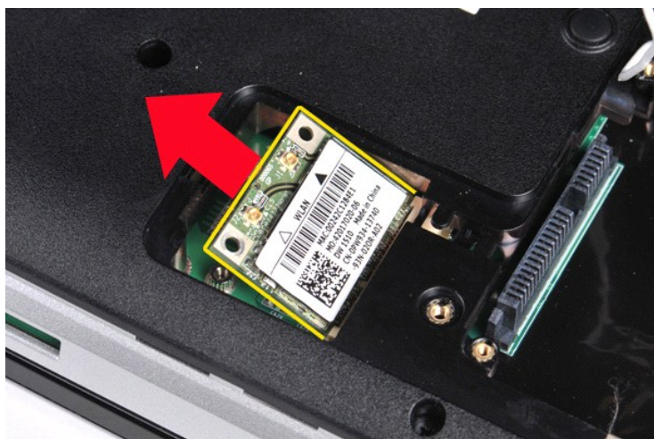
7. เลื่อนการ์ด WLAN ออกจากช่องใส่การ์ดบนบอร์ดระบบโดยทำมุม 45 องศา
