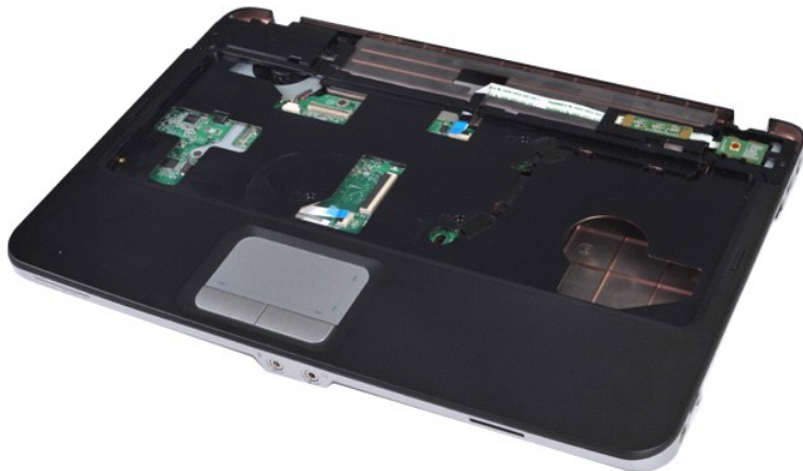
13. ถอดสกรูที่ยึดที่วางฝ่ามือกับคอมพิวเตอร์
